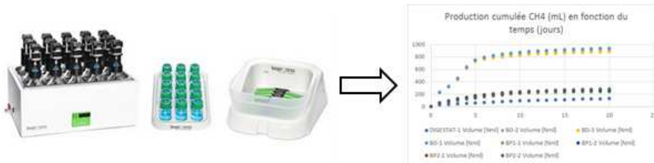
Système AMPTS* automatisé Méthanisation mésophile (37°C), 21 jours
