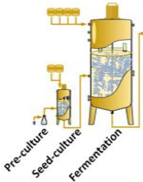
1°) Energie=> Stérilisation (Directe ou pas) / Aération (Compresseur) / Agitation (PO2 vs vitesse sur variateur) / Durée / DSP
