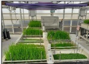
Mise en place d'un pilote pour des essais de mycorhization en hydroponie
