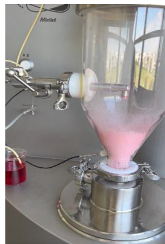
Lit d'air fluidisé (Enrobage et granulation)
