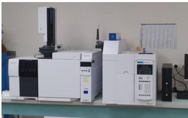
Chromatographie gazeuse couplé à la masse (avec injecteur liquide ou head-space)
