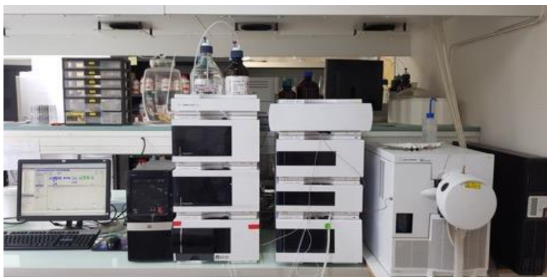
Chromatographie Liquide Haute Performance Couplée à la Spectroscopie de Masse (HPLC-MS)
