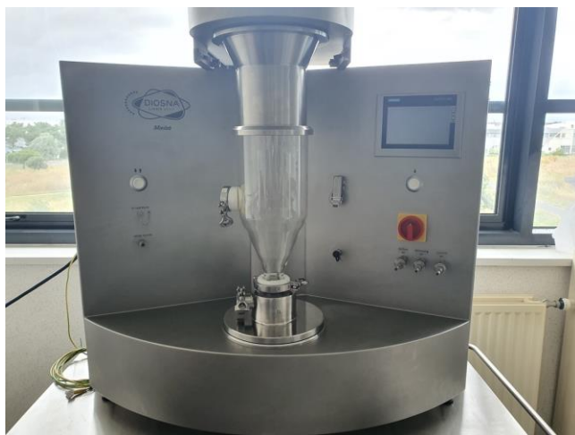
Lit d'air fluidisé (Enrobage et granulation)
