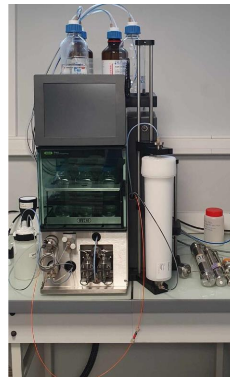
Chromatographie liquide (Hybride: basse et Haute pression)
