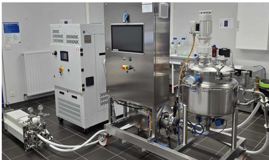
Macération 50 L avec systèmes de filtration à plaques
