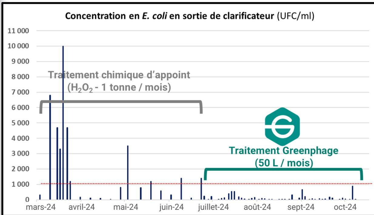
Le traitement Greenphage permet de respecter le seuil réglementaire de 1000 / mL, même avec des effluents chargés
