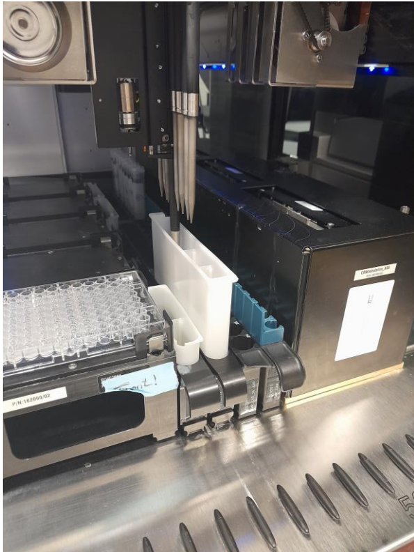
Fig. 5 Automated Liquid Handling System. Links Hamilton model, center and right, Tecan Infinite Evoware at Institut von Bioverfahrenstechnik of Technische Universität Berlin.
